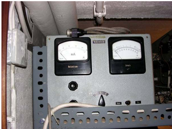
Bild: 11: Pirani Messgerät
