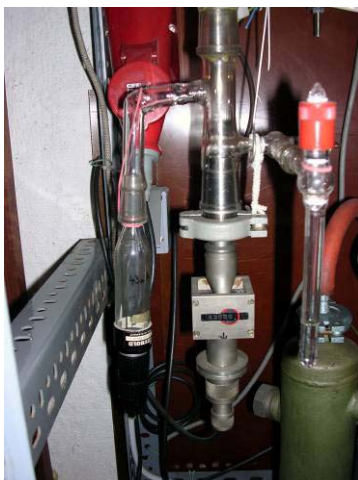
Bild 13: Messröhren. Links Pirani, Mitte Penning, rechts Behälter für Pentan zu Formierung von thorierten Heizfäden.
