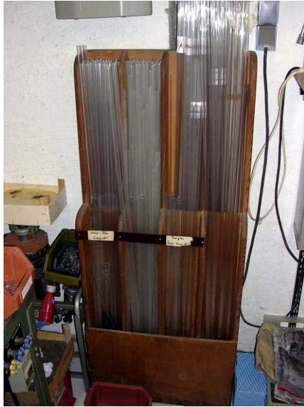
Bild 14: Rohmaterial für den Röhrenbau sind Glasrohre aus dem Handel. Sie werden entweder mit einem Glasbläserbrenner bearbeitet oder auf einer Gladitz Universalmaschine (Bild 15, 16).
