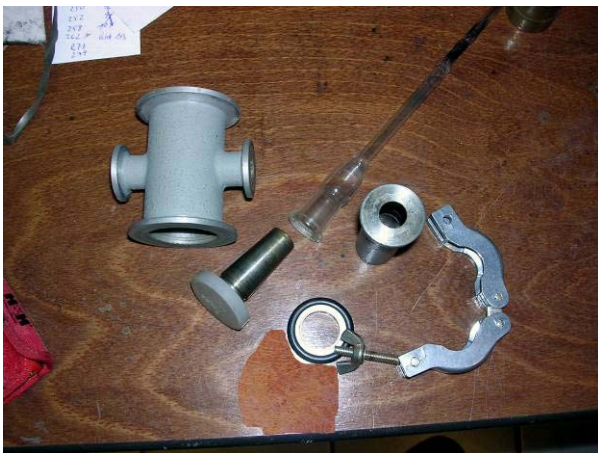
Bild 8: Kleinflanschteile mit Übergang auf Glas
