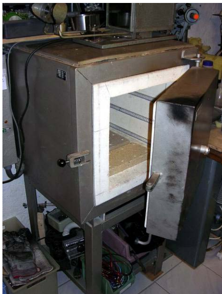
Bild 17: Bearbeitetes Glas muss in einem Auskühlofen langsam abgekühlt werden (Anealing). Besonders Weichglas ist gegenüber Temperatursprüngen empfindlich und neigt zu Spannungen und Rissen. Die fertig eingeschmolzenen Röhren (siehe mein Bericht in www.ruediger-walz.de ) werden kurz auf 500 °C erhitzt und langsam abgekühlt. Verwendet wird ein Schamotteofen von Haereus, der z.B. für Töpferzwecke gebaut wurde.
